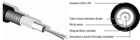
Cavo in fibra ottica armato da esterno
